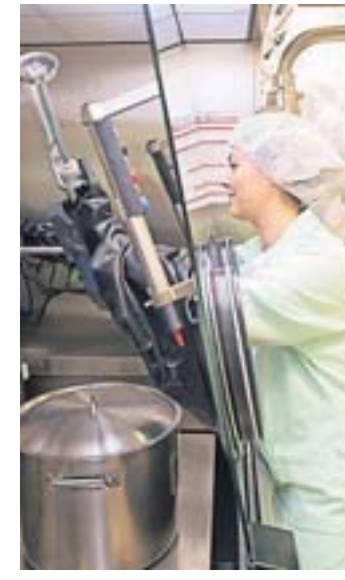
Beim Abwiegen der Arzneimittel muss das Gewicht ganz genau stimmen: Pharmakantin Natascha Zehe arbeitet an der Sicherheitswaage beim Pharmahersteller Dr. Kade in Berlin. Der Beruf erfordert technisches Verständnis und Sorgfalt.
